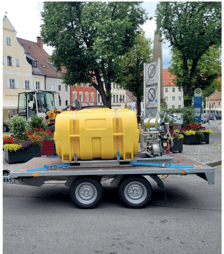
Mobiler Wassertank zur Bewässerung des Stadtgrüns während Hitzeperioden
