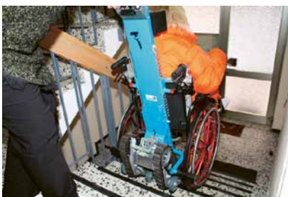
Mit einer Treppenraupe kann im Bestand ein Rollstuhl behelfsmäßig transportiert werden.
