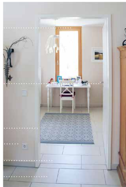
Rollstuhlgerechte Wohnung mit ausreichend großen Türöffnungen. ♣ München, Barthstraße
